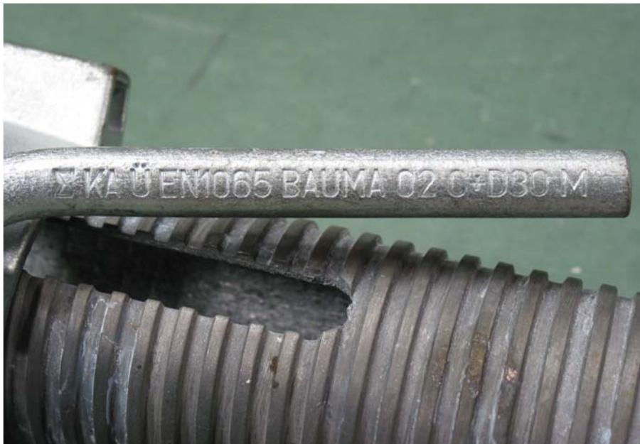
**Bild 8:** Kennzeichnung einer Baustütze nach EN 1065 und Bauregelliste A
